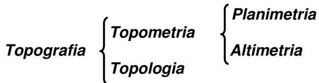
A topometria é a parte da topografia que se encarrega das medições dos elementos característicos de um terreno, sobretudo quando se visa representá-lo graficamente em uma superfície plana.
